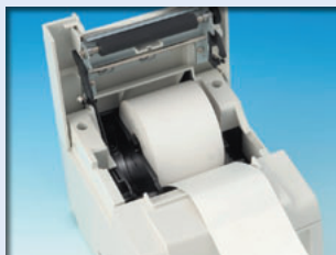
付属ガイドの装着により、58mmロール紙にも対応可能
